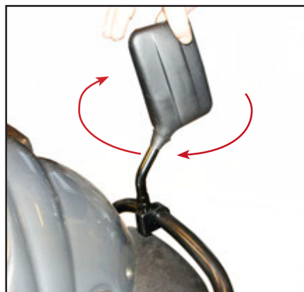
Sidospegeln monteras genom att först vrida hela spegeln runt.
