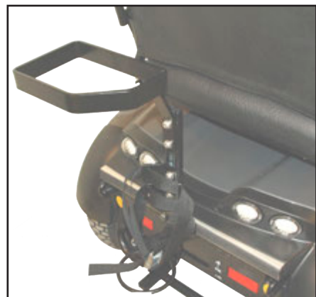
På samma sätt monteras hållare för syreapparat.
