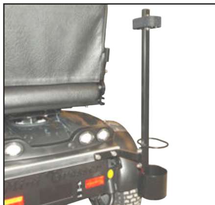
Anpassa listens längd. Montera käpphållaren i C-skenan. Montera spärren igen.
