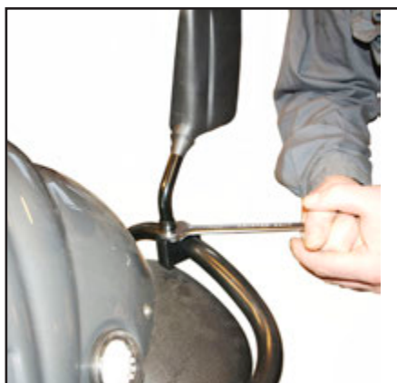
Till sist sätt spegeln som önskat och spänn kontramuttern.
