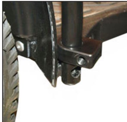
Beslaget till spegeln träs på röret. Återmontera skruv och skiva.
