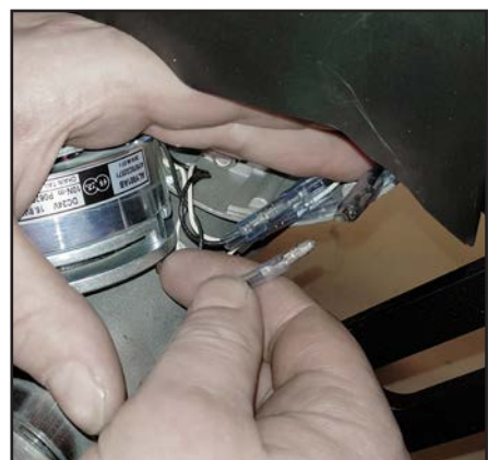
Lossa de fyra kontakterna och magnetbromsen är fri.
