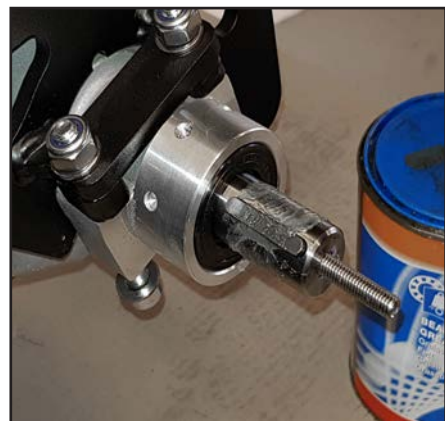
Tapen tas bort och det hela fettas in med lagerfett.
