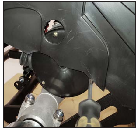
Lossa de 3 skruvar som håller kåpan.
