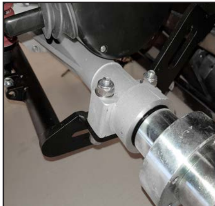
På den ena sidan ligger transaxeln ovanpå svängarmen. På den andra sidan är den under. Demontera skruvarna på denna sida först.
