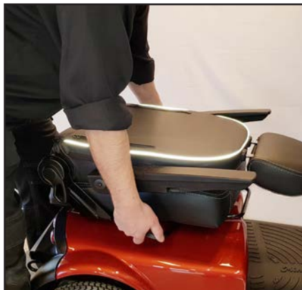
Fäll upp armstöden och sedan ryggstödet helt ned. Frilägg sätesspärren-vrid sätet lite och lyft det rakt upp.
