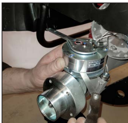
Kontrollera avståndet till magneten. Om det är större än 0,35 mm, är den sliten och skall bytas. En ny har ett avstånd på 0,15 mm.
