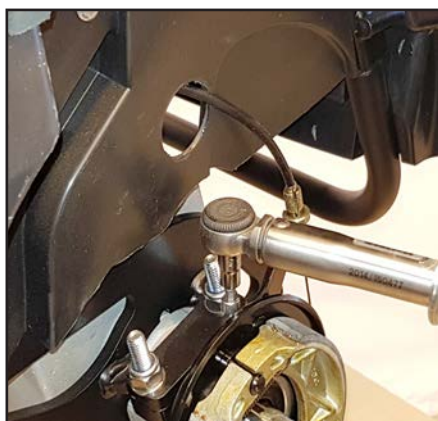
Återmontera bromsskölden. De tre skruvarna spänns med 4 Nm.
