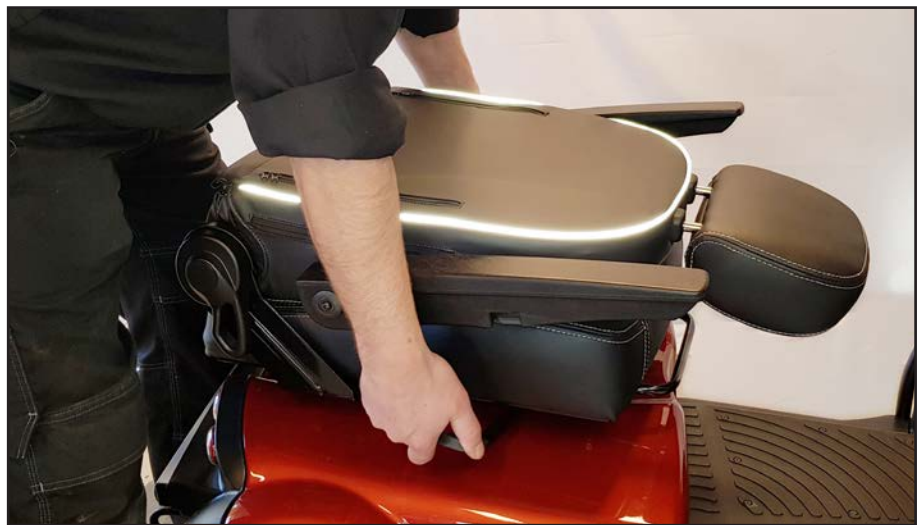
Frilägg handtaget så sätet kan vridas.. Sätet lyfts upp längs sätesröret.
