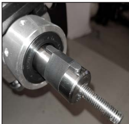
På en ny transaxel sitter kilen fast med tape vi leverans.
