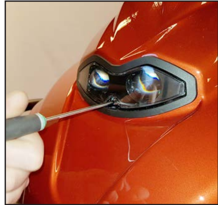
Lampan kan justeras upp/ned genom att skruva på denna skruv.
