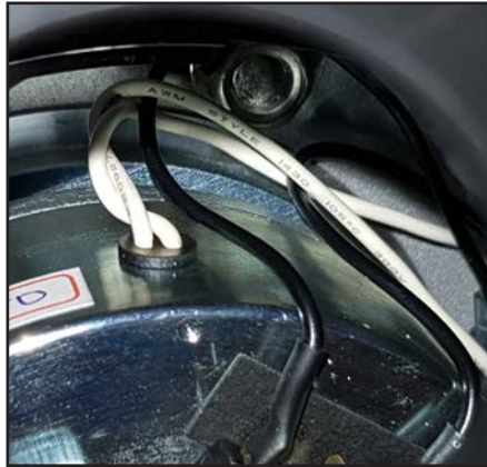
När den nya magnetbromsen skall monteras, se till att ledningarna inte kommer i klämm.
