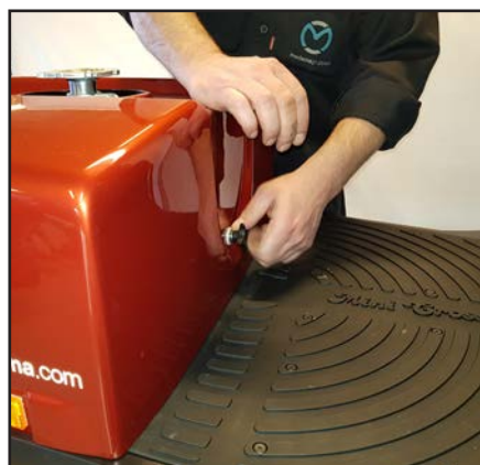
Lossa fingerskruven och lyft bort bakskärmen.
