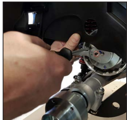
Lossa magnetbromsen med de 3 skruvarna. De har fått locktite vid montering.
