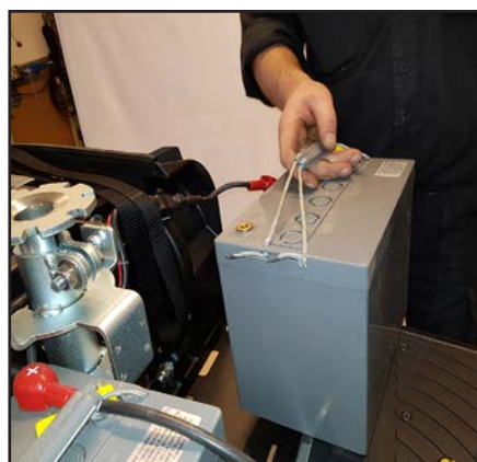
Batteriet är nu fritt och kan bytas. Ett nytt monteras i motsatt följd
