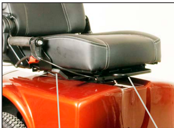
Utlösarhandtag för vridning av säte. Utlösarhandtag för säte fram/tillbaka.
