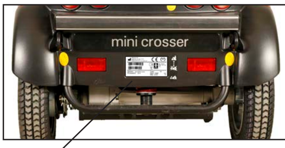
Serienummerskyltens placering på fordonet.
