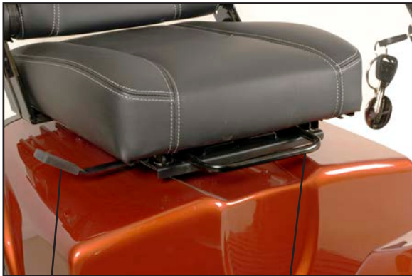
Spak för vridning av säte. Handtag för säte fram/tillbaka.
