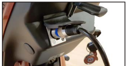
Laddningskontakten ansluts till 3-polskontakt på styrstången. Laddningskontakten är placerad under skyddsgummit.
