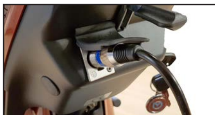
Laddningskontakten ansluts till 3-polskontakt på styrstängan. Laddningskontakten är placerad under skyddsgummit.
