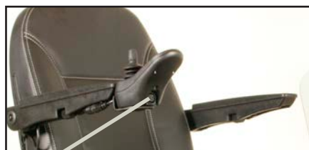
Laddkontakten ansluts till den 3-poliga kontakten på undersidan av Joysticken.
