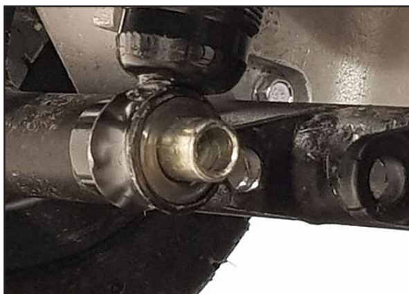
Om bussningen är ljus och genomskinlig är det rätt bussning. återmontera fjädringen.
