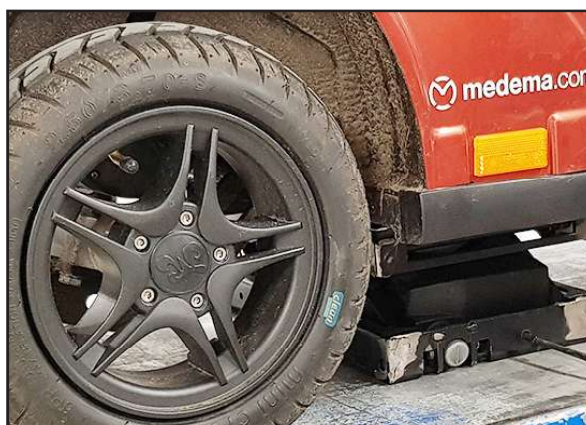
Placera lyft eller liknande under scootern så den står stabilt under demontering.
