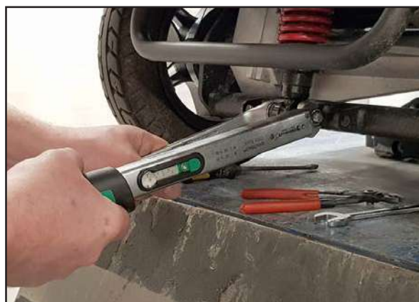
När fjädern varit helt av monterad så monteras den lättast först i övre fästet, sedan i det nedre. Använd nya brickor och muttrar. Dras åt med moment 47Nm.
