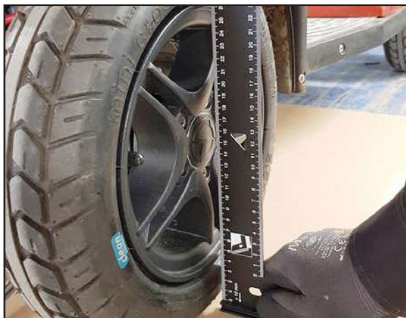
Art nr: 8035-1098 Verktøy for framhjulsinställning till X-Modell 4W. Verktøyet kan beställas från Medema.
