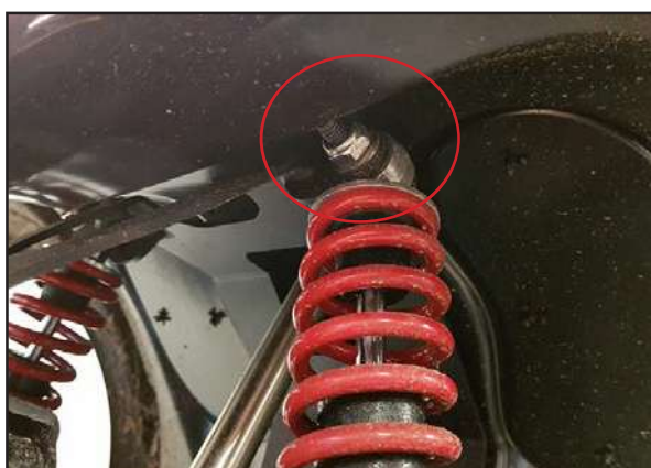
Börja med att skruva loss övre bulten till fjädringen, Pos1. Verktyg: Fast nyckel 17mm och Insexnyckel.
