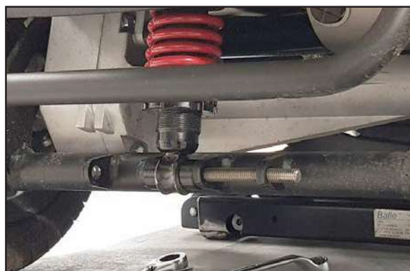
Tryck ut gängstången och vinkla ut fjädern för att kontrollera gummibussningen
