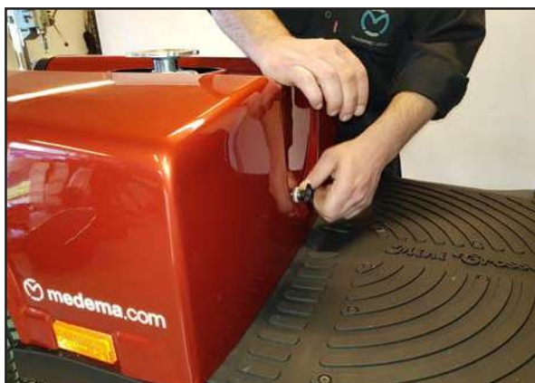
Montera av kåpan.
